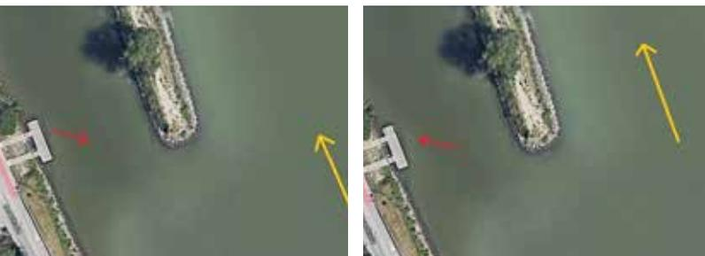
**Abb.3:** Strömungen beim Passieren eines Schiffes. Links: Bei Annäherung des Schiffes [gelber Pfeil] entsteht ein Sog [roter Pfeil], der z.B. an der Bewegung eines Stegs in Richtung Schiff beobachtet werden kann. Rechts: Passiert das Schiff, „schwappt“ das Wasser zurück, am Ufer schlagen Wellen ein. Abbildungen © 2020 CNES/Airbus, European Space Imaging, Maxar Technologies, Kartendaten ©2020
