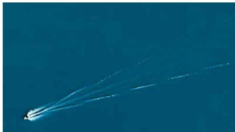
**Abb.7:** Typische Form von Motorbootwellen in Gleitfahrt. Bild © 2020 Airbus, CNES/Airbus, Maxar Technologies, Kartendaten © 2024
