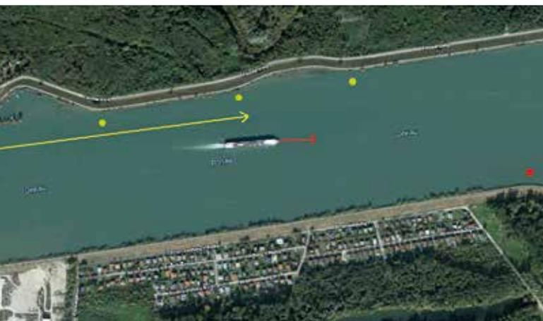
**Abb.1:** Markierung der Schifffahrtsrinne. Auf der Donau ist die Schifffahrtsrinne mit grünen Bojen (auf der Steuerbordseite stromaruffahender Berufsschiffe) bzw. roten Bojen gekennzeichnet. (Im Bild ist ein stromabfahrendes Schiff erkennbar.) Anstelle von Bojen kann auch das Ufer selbst die Begrenzung der Fahrrinne darstellen. Abbildung © 2020 CNES/Airbus, European Space Imaging, Maxar Technologies, Kartendaten ©2020
